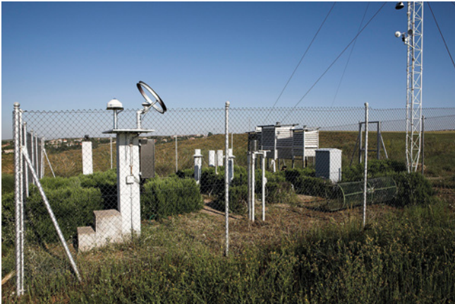
13. Jardín meteorológico. En este recinto vallado se disponen la mayor parte de los instrumentos que se utilizan en los observatorios meteorológicos. En el de la imagen, en primer término a la izquierda, tenemos el pedestal donde se sitúan los piranómetros con los que se mide la radiación solar, mientras que detrás, en la columna del fondo, está el heliógrafo. En la parte central se localizan los pluviómetros y pluviógrafos, seguidos, más a la derecha, de las garras meteorológicas y la torre anemométrica.
